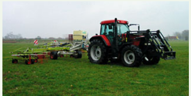
Abb. 6: Bakteriendosierer am Schwader mit 100-, 200- oder 400-Liter-Behälter
