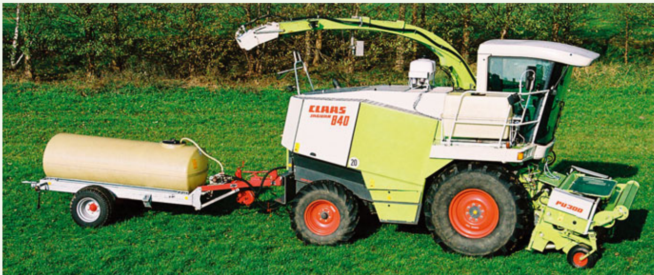
Abb. 4: Kombination von automatisch geregelten Melasse-, BIO-SIL ®1) und Sila-fresh 2) -Dosierern am Häcksler
