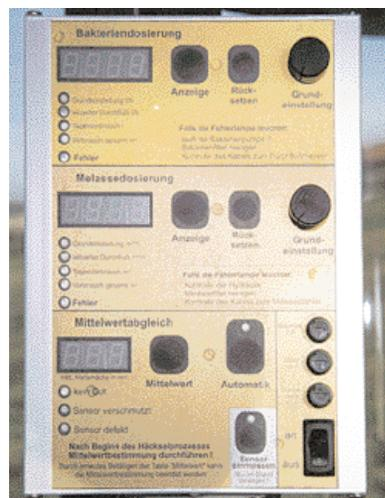
*Abb. 20: In der Häckslerkabine: Bedienoberfläche des Steuercomputers*
