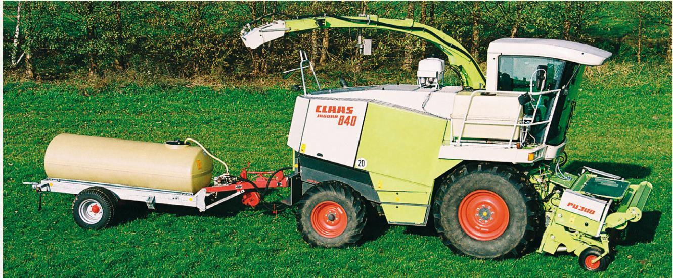
Abb. 4: Kombination von automatisch geregelten Melasse-, BIO-SIL<sup>®</sup>) und Silafresh<sup>2)</sup>-Dosierern am Häcksler
