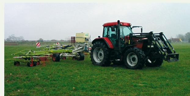
Abb. 6: Bakteriendosierer am Schwader mit 100-, 200- oder 400-Liter-Behälter
