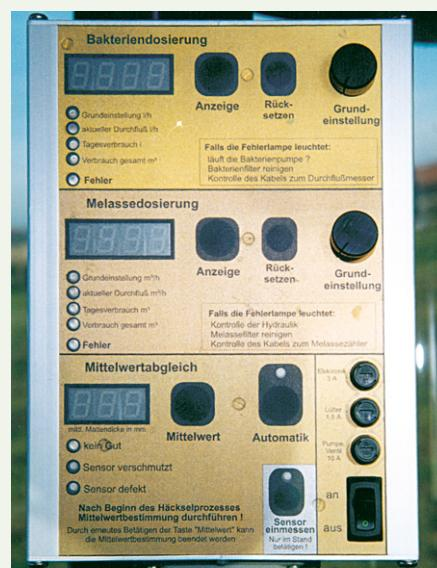
Abb. 3: In der Häckslerkabine: Bedienoberfläche des Steuercomputers
