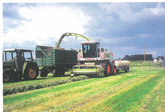
Abb. 21: Häcksler mit Melas- seapplikation bei der Grassilagebereitung
