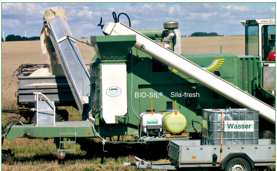
Abb. 19 Dosierer an der Mühle: Für BIO-SIL® , Sila-fresh (bei sehr hohen Anforderungen an die Stabilität) und für Wasser
