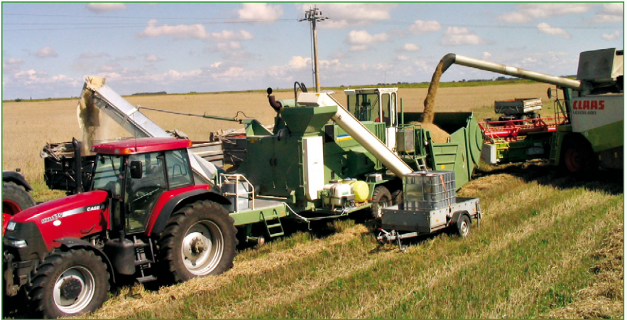
Abb. 18 Technologische Kette zur Gewinnung von silierfähigem Getreideschrot
