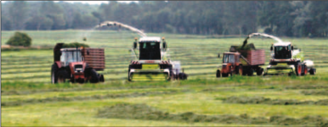
Abb. 1 Bergung des Siliergutes mit vollständig getrennten Häckselketten
