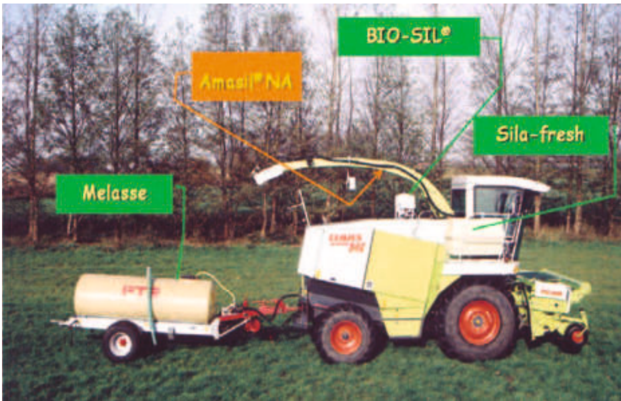
Abb. 19 Technische Lösung zur getrennten Applikation von BIO-SIL® und Melasse, Sila-fresh (Kaliumsorbit) bzw. Amasil® NA
